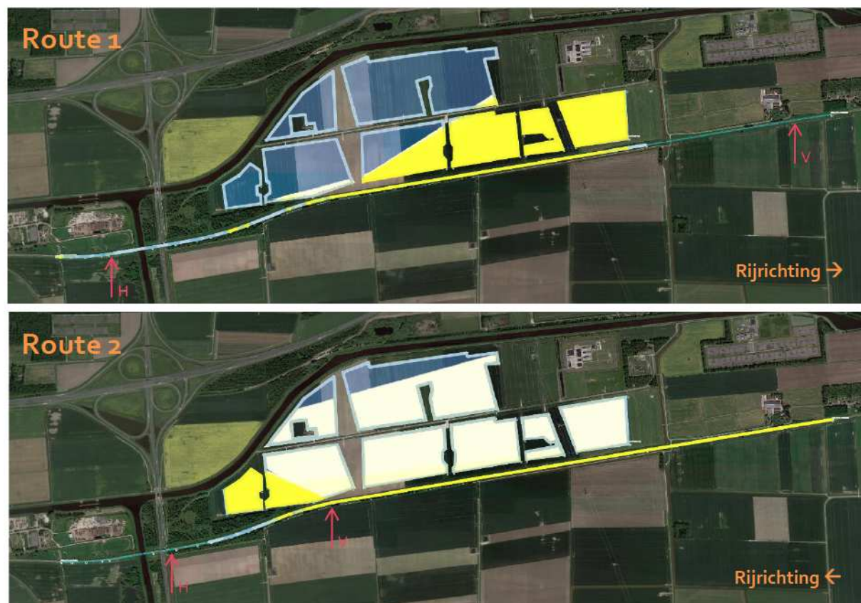
Figuur 4.2: Schitterende delen van de zonnepanelen, zichtbaar vanaf de routes en de plekken op de route waar de reflectie tot hinder leidt. Hoe geleer de kleur, hoe meer reflectie. Relevante seinposities zijn met een rode pijl aangegeven, een H voor hellingseinen, een V voor voorseinen. Boven: Route 1, onder: Route 2.
